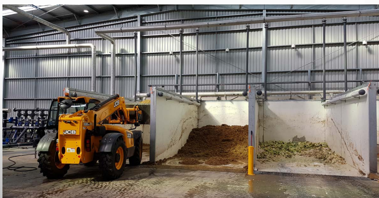
Los substratos sólidos se almacenan en búnqueres justo al lado del dosificador.
